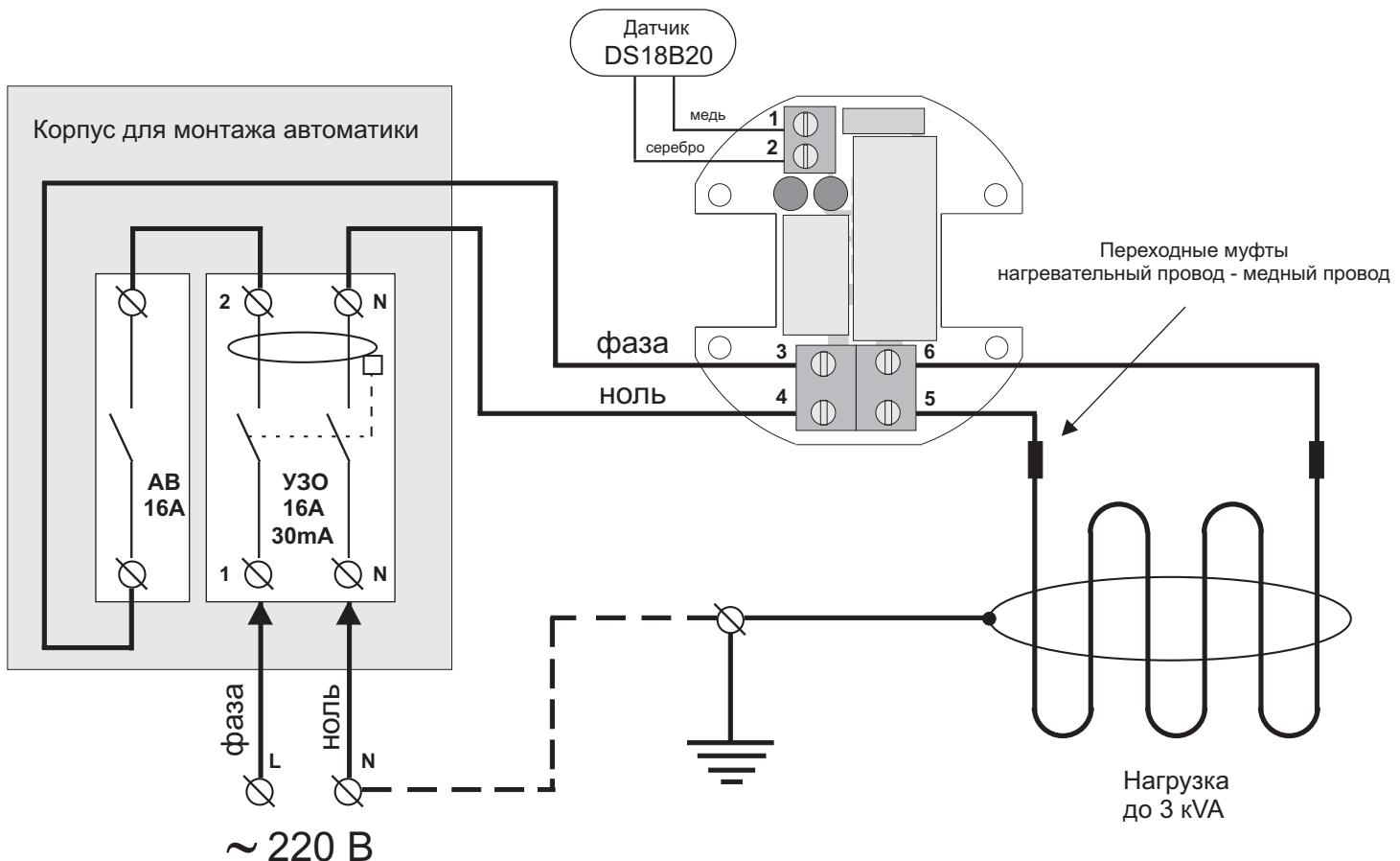
Рисунок 1. Электрическая схема монтажа системы “теплый пол”.
