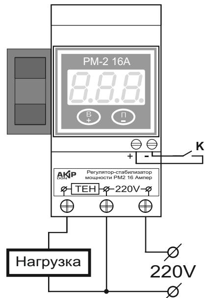
Рис. 1. Схема монтажа прибора.
