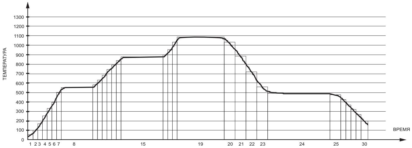
Рис.4 Условная схема профиля техпроцесса на 30 заданий (позиций) температура-время.
