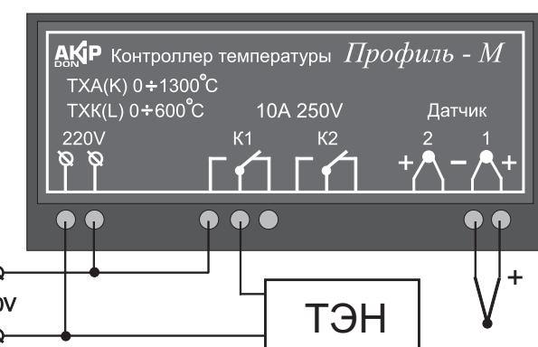
Рис. 2. Монтажная схема системы. Применяется при условии, что мощность нагревательного элемента не превышает 1,5 киловатта.
