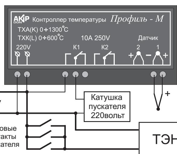
Рис. 3. Монтажная схема системы. Применяется при условии, что мощность нагревательного элемента превышает 1,5 киловатта. Тип пускателя определяется мощностью нагрузки (TЭНов).
