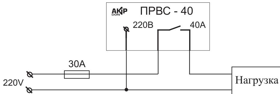
Рис. 1 Схема подключения.
