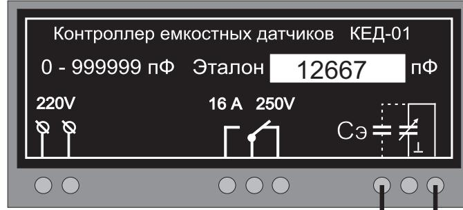
Датчики к прибору желательно подключать экранированным проводом если они находятся на значительном расстоянии. Экран подключать к вводу клеммы обозначенной  $\perp$ . Рекомендация желательная в случае наличия электромагнитных помех (выражается в значительных колебаниях показаний), в противном случае любым проводом.
