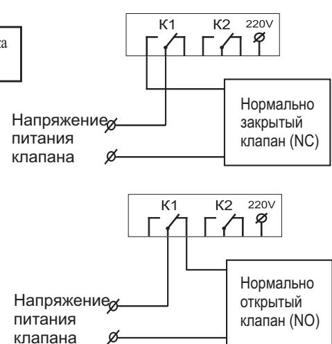
Рис. 3. Схема подключения нормально закрытого (NC) или нормально открытого клапана (NO) при использовании первого канала прибора в качестве ШИМ.
