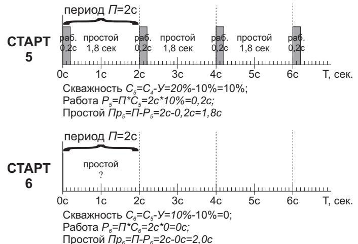
Рис. 4. Описание логики и схемы работы ШИМ. Период  $P=02,0\text{ с}$ , Скважность  $C=50,0\%$ , Уменьшение  $Y=10,0\%$ . Начиная с 6 «старт-стопа» за счет функции декремента прибор уже не будет подавать питание на клапан.
