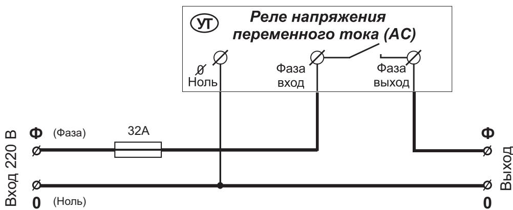
Рис.1 Схема подключения прибора. В качестве предохранителя может быть плавкий предохранитель или токовый автомат соответствующего номинала.
