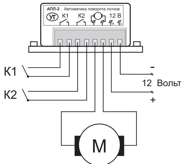
Схема подключения АПЛ-2
